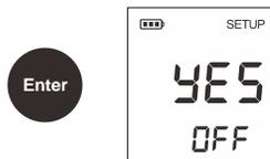
① 当自动关机功能启用后，如果您在 8 分钟内无任何按键操作，仪表将自动关闭以节省电源。
