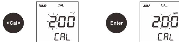
4. 按 ENTER 键，仪表开始校准，等待校准值稳定后，屏幕自动显示“END”，校准完成。
