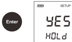
① 当自动锁定功能启用后，仪表将自动侦测一个稳定的终点测量值并锁定。再次按 HOLD 键，恢复测量。
