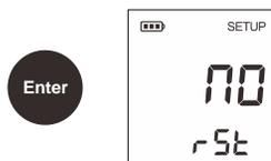
**警告：**RESET 功能将恢复所有参数至工厂默认状态，如果仪表当前处于相对 mV 模式(R.mV)，重置后将转为 mV 模式。
